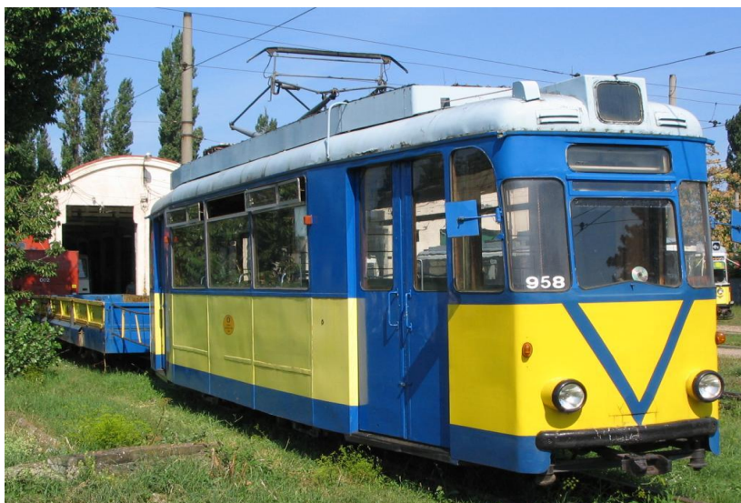
Foto 144. Tramvai provenit de la S.V.Z. Zwickau, cu remorcă de transport materiale executată în atelierele proprii dintr-un vagon remorcă Gotha.
