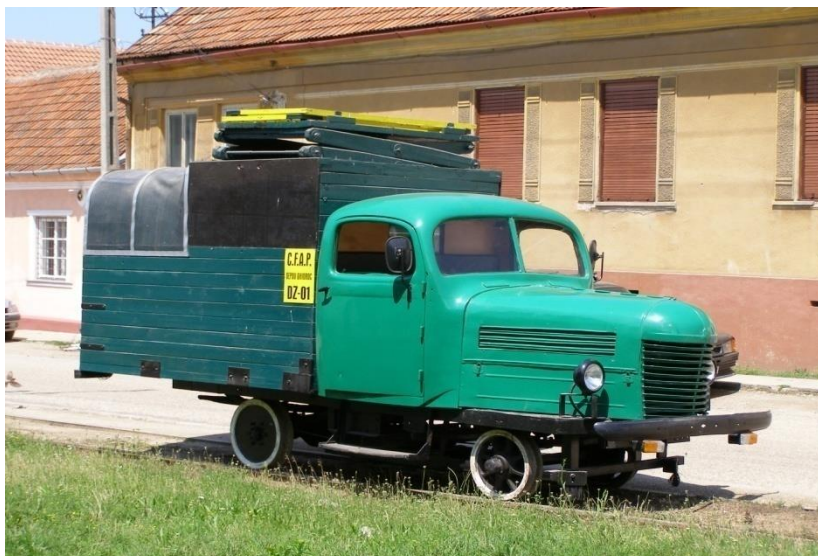
Foto 241. Drezina de intervenție construită în anul 1948, în atelierele C.F.A.P. pe șasiul unui camion Praha, s-a reparat în 2003.
