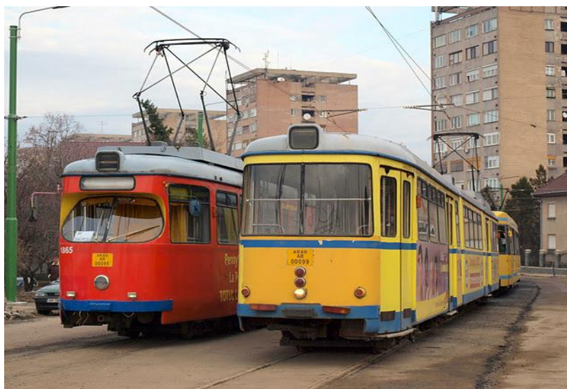
Foto 174. Tramvaie GT8 și M8S, pregătite pentru probe de încărcare statică a podului Traian, după reparația din anul 2011. S-au folosit 10 vagoane, cu o masă de 35 t. fiecare, care au staționat câteva ore pe pod, conform testului.
