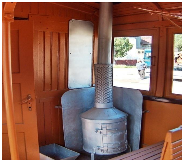
Foto 246. Soba cu lemne pentru încălzirea vagonului de călători.
