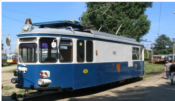
Foto 230. Tramvai revizie rețea de contact.
