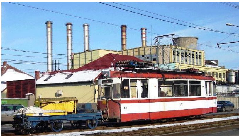
Foto 143. Tramvaiul Gotha de la Halberstadt, cuplat cu o perie rotativă de curățat zăpada, produsă în atelierele societății de transport.
