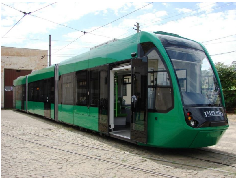
Foto 195. Tramvaiul Imperio în depoul UTA; a se remarca înălțimea redusă a podelei, cca. 30 cm.
