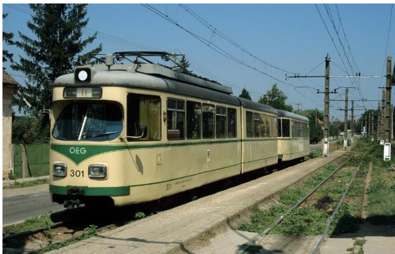
Foto 152. Cuplu de vagoane GT-6 cu remorca B4 pe 4 axe, preluat în anul 1997, de la O.E.G. Mannheim; s-au preluat trei astfel de trenuri, amenajate pentru distanțe de transport mai lungi.
