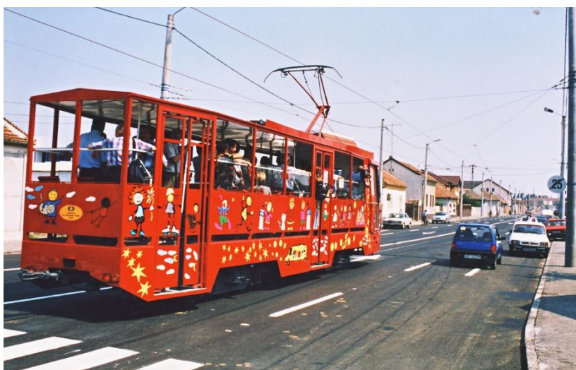
Foto 136. Vagon turistic de vară, construit la Astra Vagoane, în anul 1995, pe structura unui vagon utilitar tip electrobasculă ITB.
