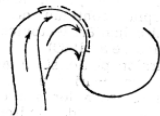
Erodarea laterală și spre avale a malului concav.
